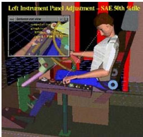
그림 1. SAE 50%ile 인체모델을 이용한 버스 운전공간 평가
